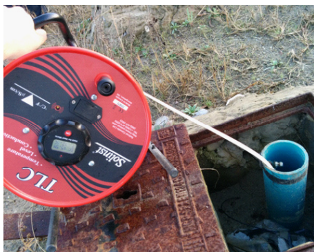
Sonda multiparametrica TLC107 Solinst, utilizzata per la misurazione dei profili di conducibilità elettrica specifica dell'acqua di falda.
