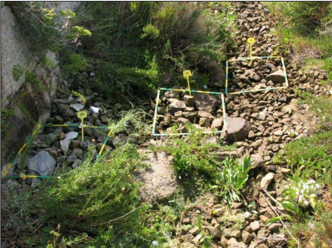
Foto 6.8 – Stazione 3: posizionamento dei tre campioni lungo un transetto rivolto dal margine della diga (campione A) verso la parte più infossata della pozza di sifonamento (campione C).
